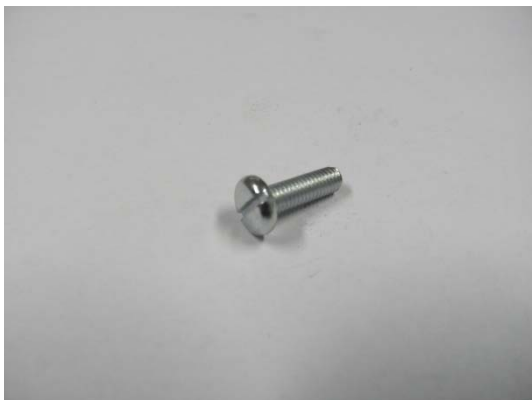
TA005091 SCREW FLAT HEAD DIN 85 M 5.0X 16.0
